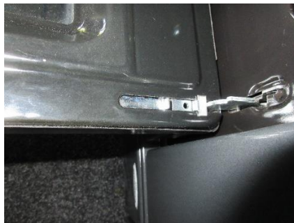
Obr. 20a Kovová západka pantu v poloze při běžném provozu
