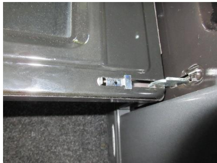
Obr. 20a Kovová západka pantu v poloze při běžném provozu
